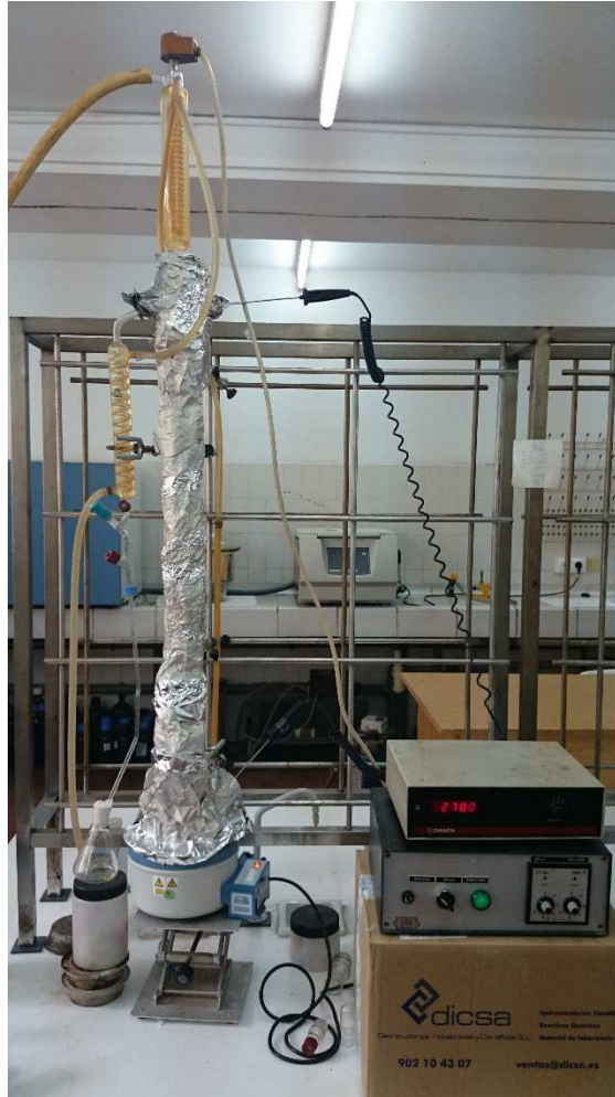
Figura 28. Instalación experimental para la purificación de la glicerina cruda.
