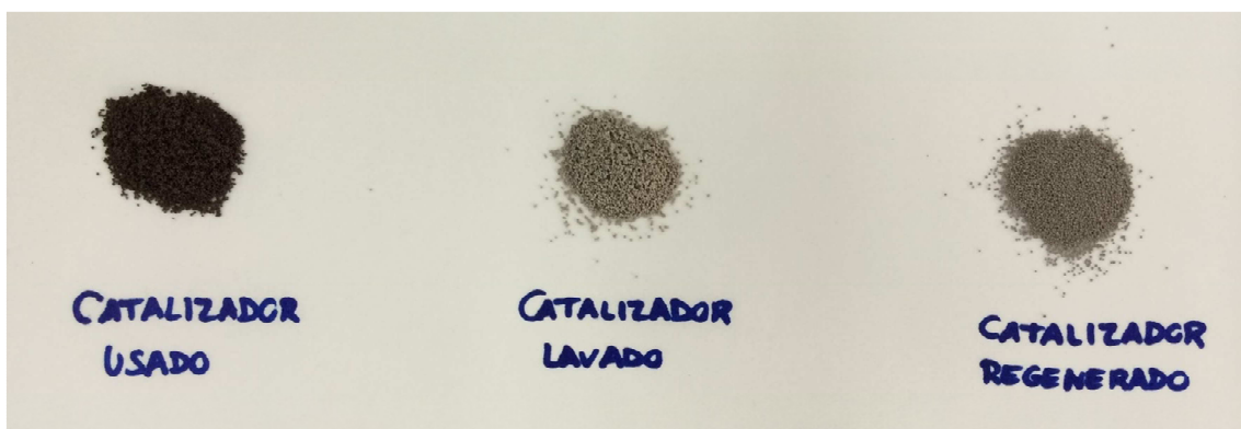
Figura 54. Fotografía que muestra las diferencias en el aspecto del catalizador en cada etapa del proceso.
