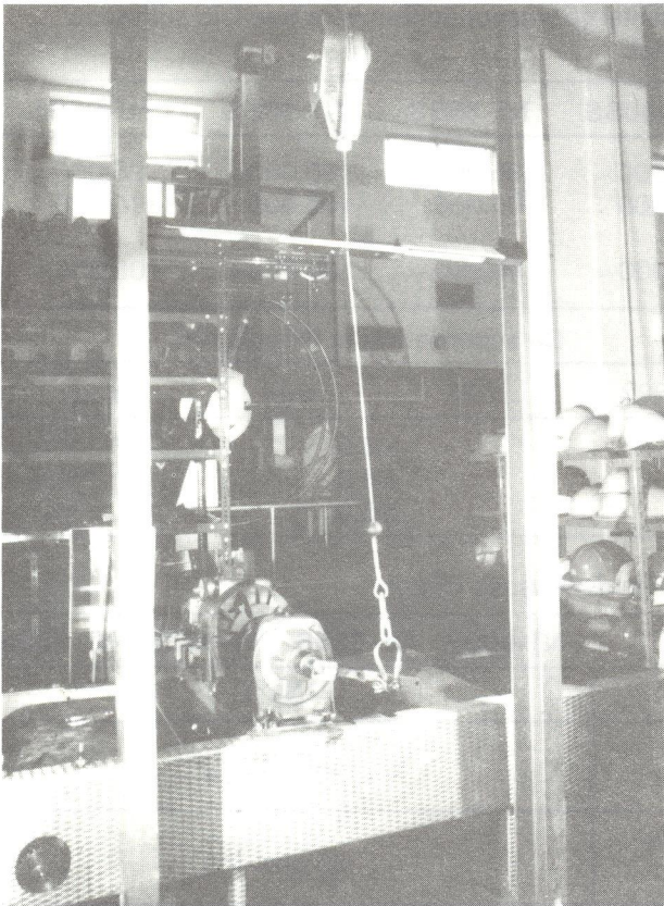
ENSAYO DE FATIGA DE UN DISPOSITIVO ANTICAÍDA DE ENROLLADOR.
