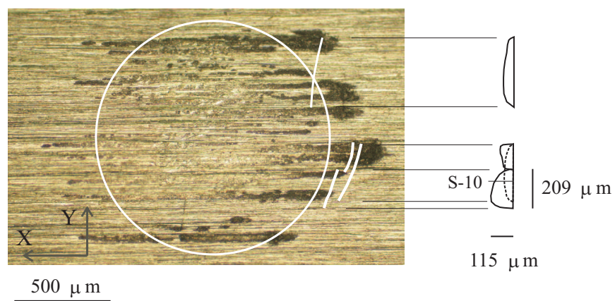
Figura 4.10: Huella por fretting y perfil de grieta del ensayo 60-60-NF (zona A); a = 609 \mu\text{m} .
