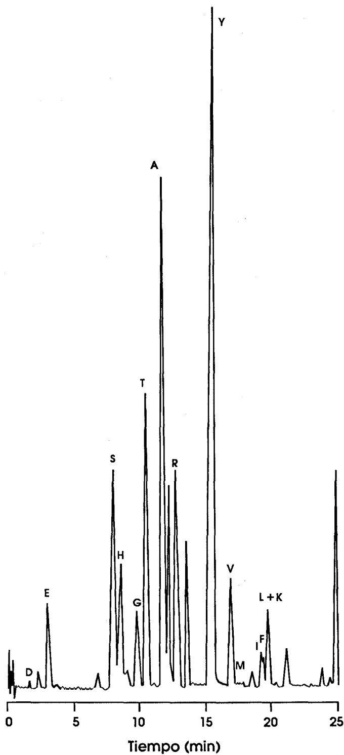
Figura 11. Separación de los OPA derivados de aminoácidos patrón (50 nmoles de cada aminoácido) en condiciones isocráticas. Solvente (v/v): 50% fosfato sódico 40 mM pH 6,5; 22% metanol; 2% tetrahidrofurano y 26% agua destilada y desionizada. Flujo: 2 ml/min. Tamaño de la muestra 20 \mu l.
