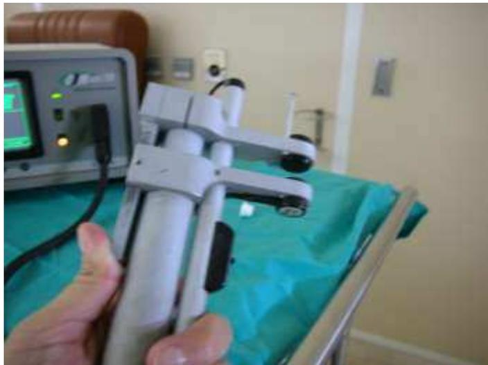
**Figura 3.2. Calibre del DBM SONIC 1200**
