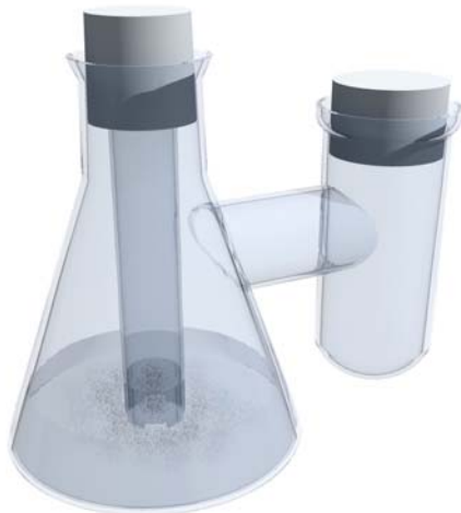
Figura III.3 Dispositivo para el estudio de la quimiotaxis frente a NAPLs en matraces biométricos
