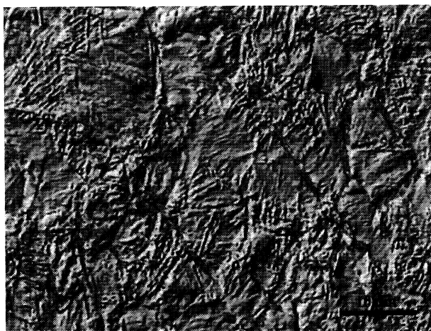
Figura 2. Muestra deformada en frío por laminación del 50 %, mostrando las típicas bandas de deformación. (Imagen por contraste diferencial de fases, Nomarski).
