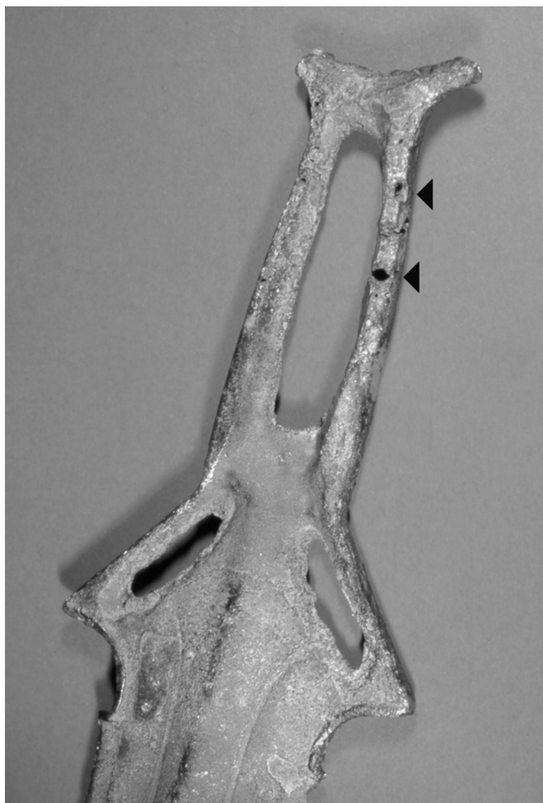
Fig. 9. Detalle de la empuñadura de la espada 4 mostrando porosidades de fundición.
