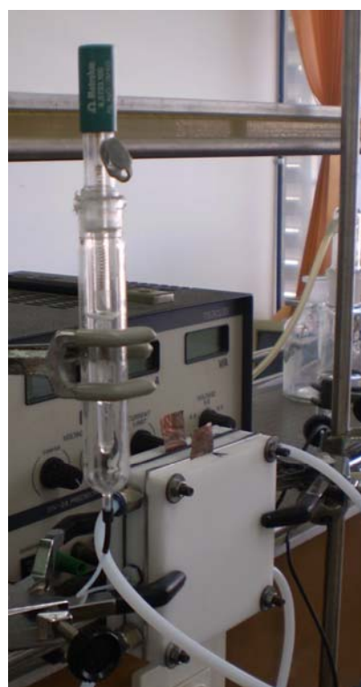
Figura 4.20. Imagen detallada del electrodo de referencia con el Luggin conectado al reactor.
