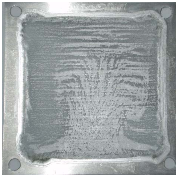
Figura 4.32. Imagen del ánodo de Al tras finalizar una electrólisis del TC en un reactor filtro-prensa
