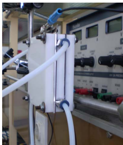
Figura 4.22. Imagen lateral del reactor filtro-prensa con las conducciones de entrada (inferior) y salida (superior) de electrolito.
