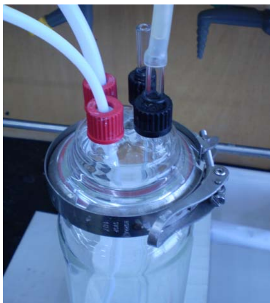
Figura 4.23. Vista superior del depósito en donde se aprecian las conexiones de las líneas de entrada directa y de realimentación de electrolito así como la entrada y salida de gases.
