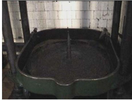
Fotografía I.46. Carrito o unidad móvil donde se recogen el aceite y el alpechín provenientes de los capachos.
