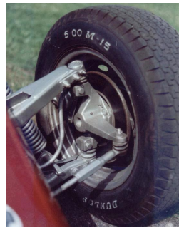
Figura 2.4: Direccionamiento de la rueda mediante varilla y husillo
