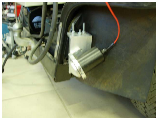
Figura B.6: Sensor Doppler instalado en el ROMEO 4R
