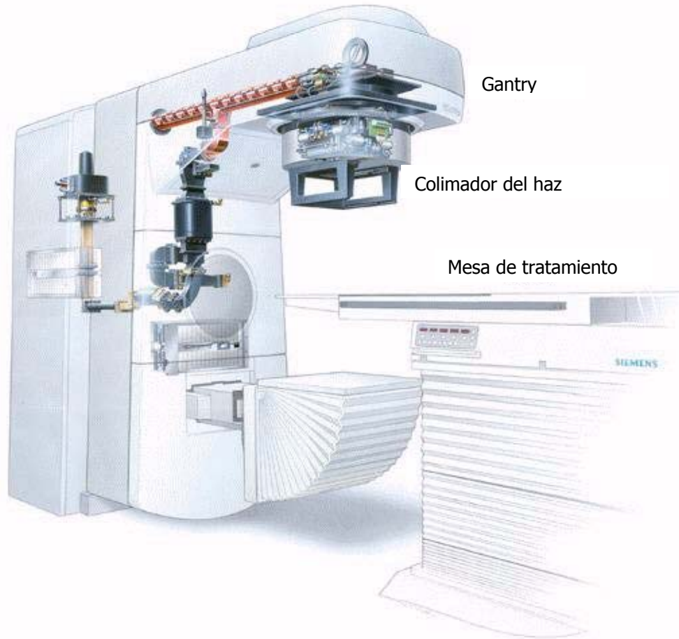
Figura 1.1.1. Esquema de los diferentes componentes de un Siemens Primus Linac de última generación.
