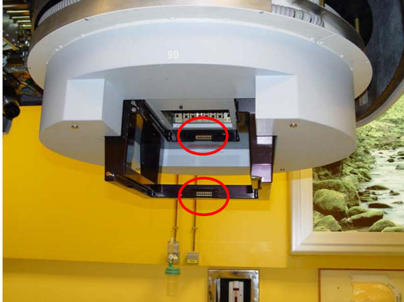
Figura 2.5.2.1.1. Conexiones para cerrar electrónicamente los circuitos asociados a las bandejas (conexión superior) y los aplicadores (conexión inferior).
