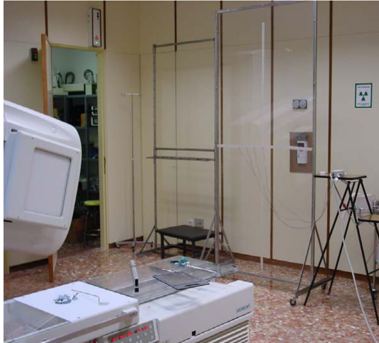
Figura 2.5.2.2.1. Situación del equipo de medida en el bunker durante las medidas experimentales de los perfiles de homogeneidad.
