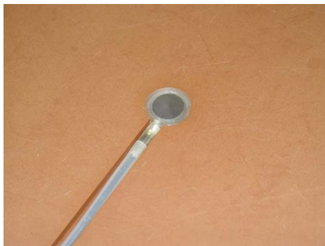
Figura 2.5.1.2. Situación de la cámara plano paralela en el alojamiento específico del fantoma.
