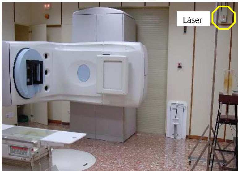
Figura 2.1.1. Disposición en el bunker del láser adicional instalado para la ICTe- y su situación con respecto al Linac.
