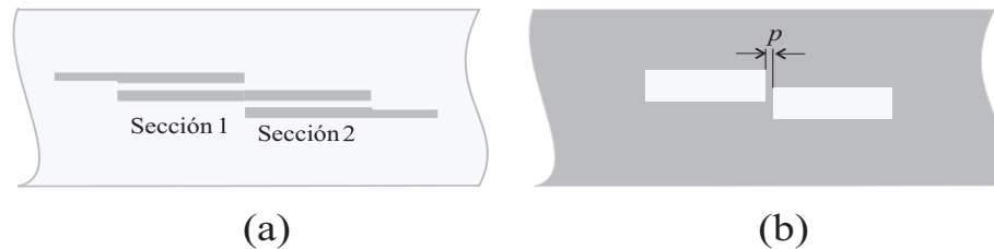
Figura 1.10: Geometría del filtro de orden N = 1 : (a) cara superior. (b) cara inferior.
