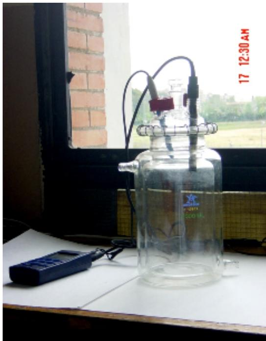
Figura II.10. Reactor de vidrio utilizado como FBR cerrado.
