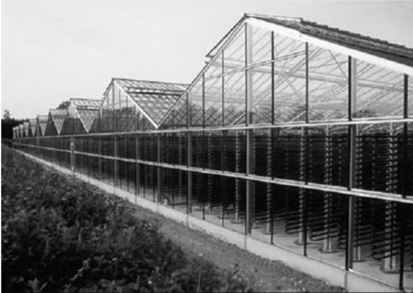
Figura I.10. Fotobiorreactor de tubo de vidrio ( $700 \text{ m}^3$ ), usado en producción de *Chlorella*.
