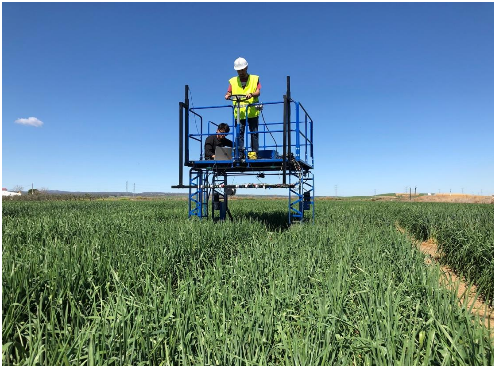
Figura 1.10 Plataforma de detección de enfermedades con sensor LiDAR incorporado.
