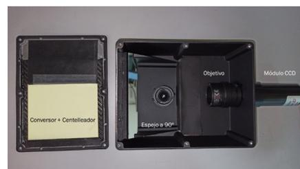
Detalles de una de las cámaras de imagen (100 x 80 mm NeutronOptics compact neutron/gamma) utilizadas en los sistemas de radiografiado y tomografía
