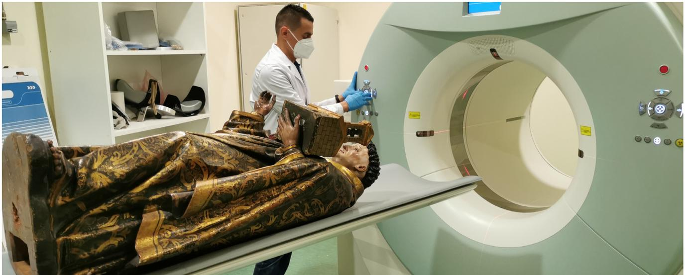
CT (sistema de tomografía computarizada) de una escultura realizado en el equipo de tomografía computarizada (PEC-CT) del CNA
