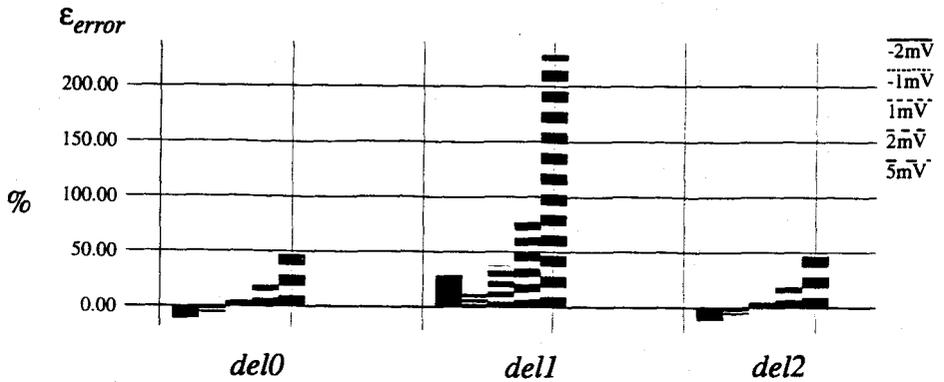
Figura 5.9 Porcentaje de error en el rizado para diversos valores  $\Delta v_f$  ( $-2mV$ ,  $-1mV$ ,  $1mV$ ,  $2mV$  y  $5mV$ ).
