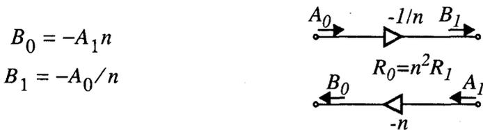
Figura 3.14 Modelo de onda de un transformador para realizaciones en modo de corriente.
