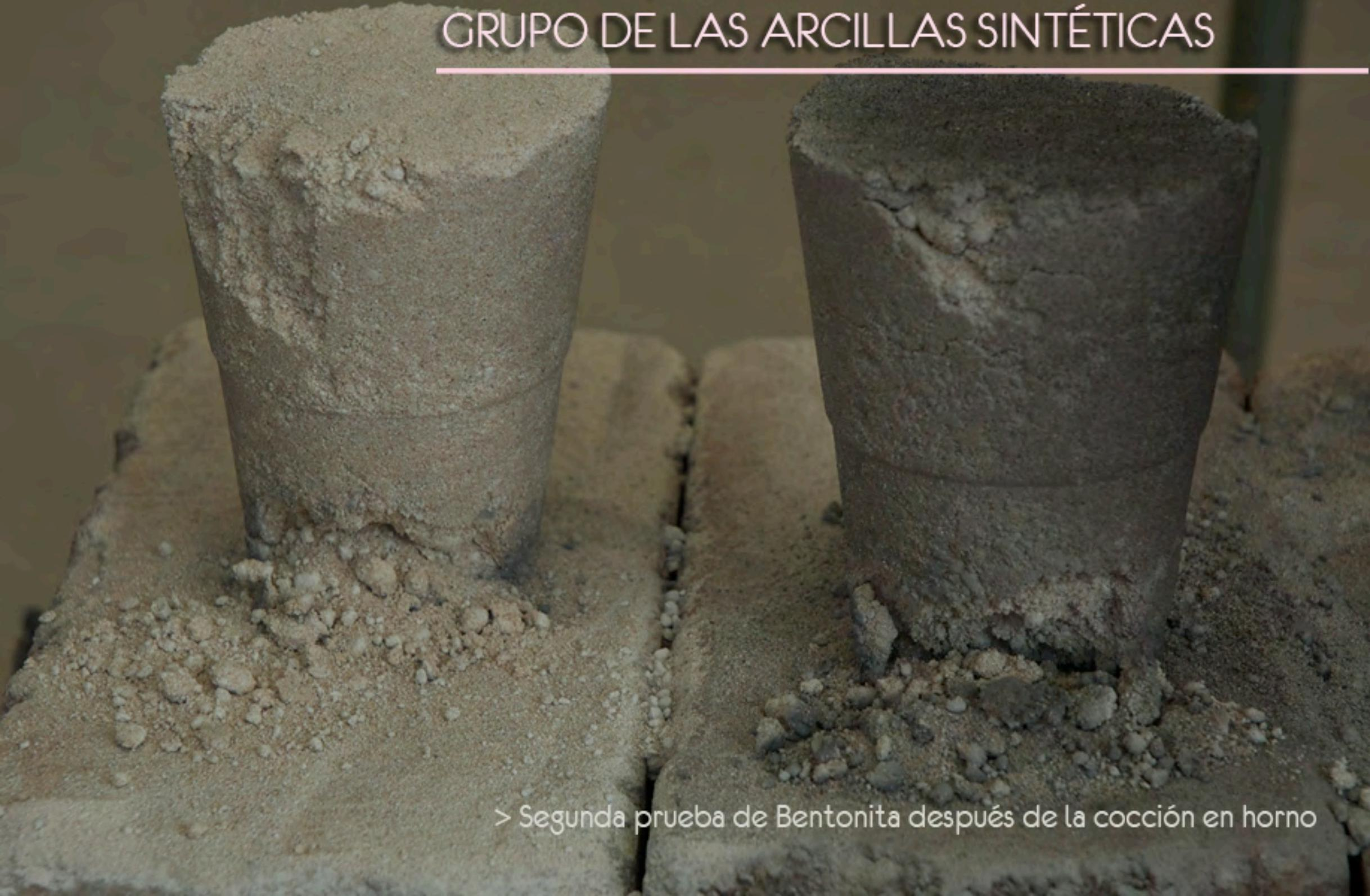
> Segunda prueba de Bentonita después de la cocción en horno
