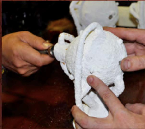
*Arenas aglutinadas con Silicato de Sodio y Silicato de Etilo*
