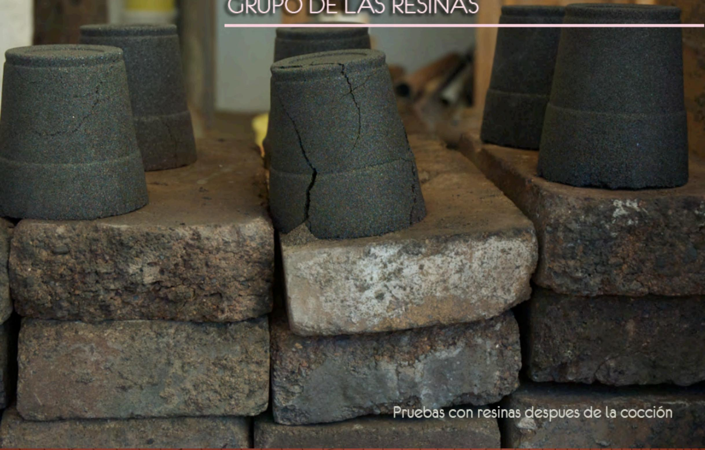
Pruebas con resinas despues de la cocción
