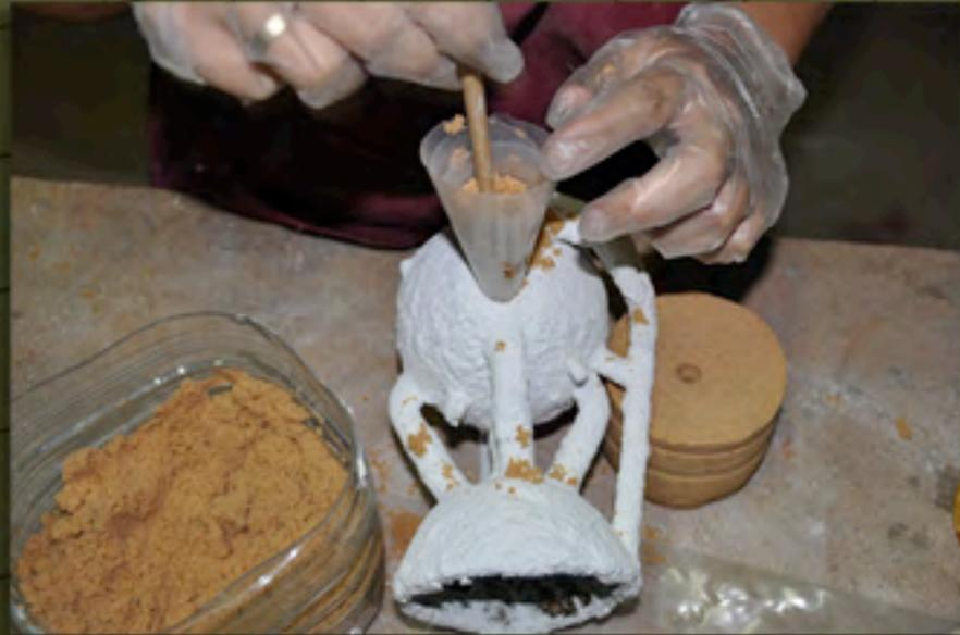
2) Incorporación y compactado de la arena aglutinada con el silicato de sodio al 6%.
