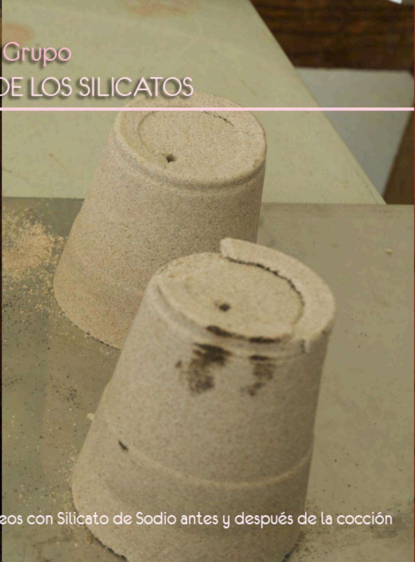
> Pruebas de núcleos con Silicato de Sodio antes y después de la cocción
