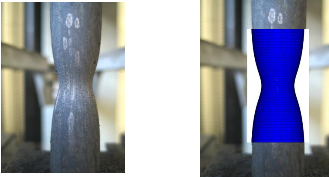
Fig.2.37.-Imagen de la probeta en el momento de la rotura y montaje con la malla de elementos finitos obtenida tras la simulación.
