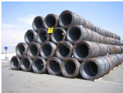
Fig. 3.20.-Almacenamiento de alambrón.
