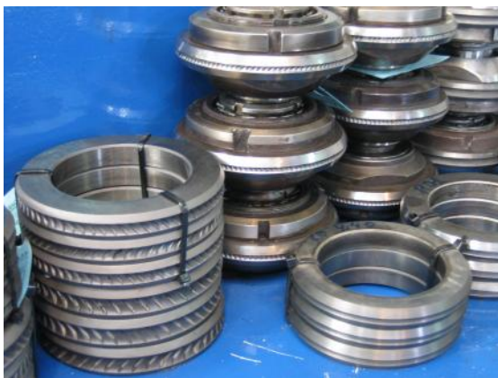
Fig. 3.18.- Distintos tipos de rodillos laminadores , según diámetro del alambón y geometría final deseada.
