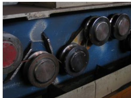
Fig. 3.25.-Decapadora. Detalle de los rodillos
