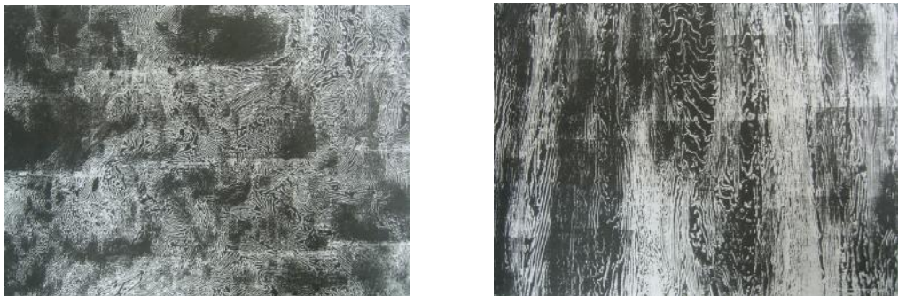
Fig 3.41 y 3.42. Corte transversal y longitudinal ( según el eje ) de un alambre trefilado. Se pueden apreciar la orientación de las láminas según la dirección del trefilado.( Gil Sevillano , 1980 ).
