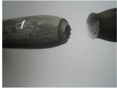
Fig.3.3.-Rotura de la probeta en la estricción.
