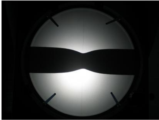
Fig 3.75.-Muestra 1.Estricción correspondiente a % Ar =0 D_0 = 8.950 mm D_f = 4.687 mm DUCT = 129 %
