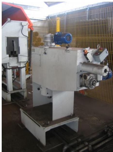
Fig. 3.26.- Jabonera para lubricación del acero antes del laminado.
