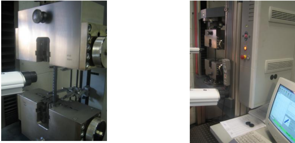
Fig 2.18.-Instalación de cámaras de vídeo sobre la máquina de ensayos.
