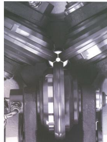
Fig.3.30.- Detalle de los rodillos laminadores. Obsérvese la milimétrica separación de los rodillos.
