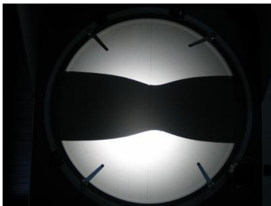
Fig 3.77.-Muestra 1.Estricción correspondiente a % Ar =0 D_0 = 13.642 mm D_f = 7.568 mm DUCT = 118 %
