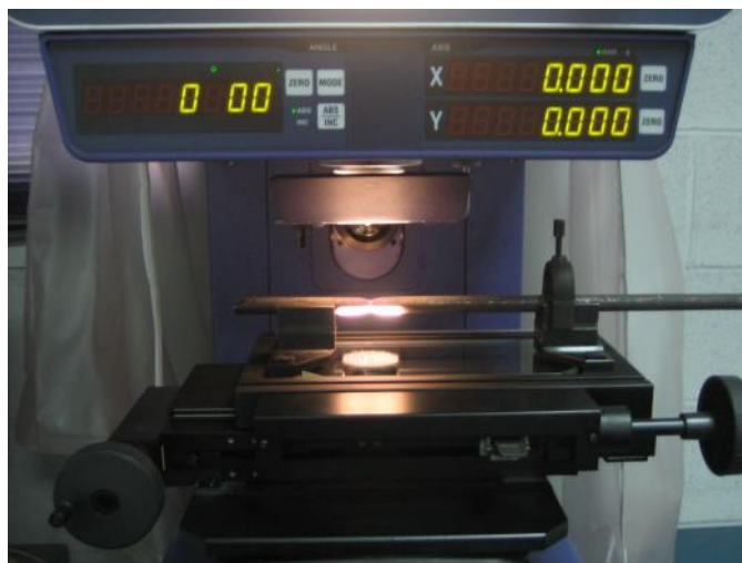
Fig.3.5.-Disposición de la muestra en el proyector de perfiles.
