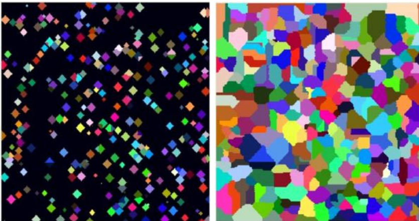
FIGURA 15. Simulación de la transformación L \rightarrow S . (imagen izquierda) Situación intermedia, (imagen derecha) situación final, (imagen central abajo) evolución de la fracción transformada frente al número de iteraciones (nótese la concordancia con el perfil que predice la ley de Avrami). Para esta simulación se ha empleado una cuadrícula de 250 x 250, con una concentración de celdillas potenciales del 2% y una probabilidad de 0.2.
