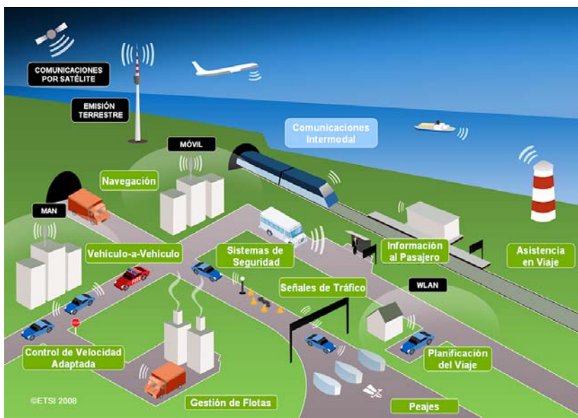
Figura 2. Escenario de comunicación ITS según la ETSI
