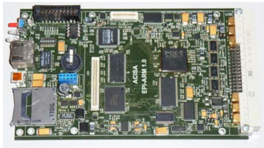
Figura 17. Placa base de un equipamiento ITS de visión artificial
