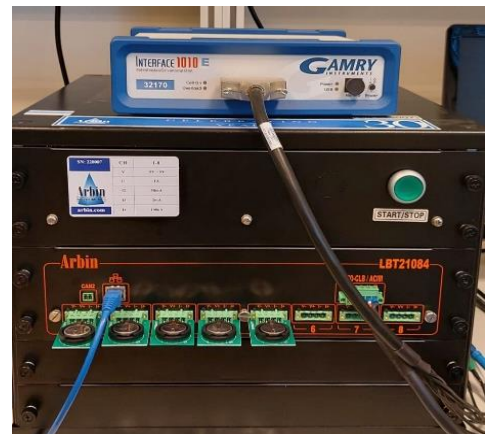
Imagen 4.14: HPS battery test system y Interface 1010E Gamry midiendo distintos EDLC
