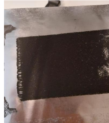
Imagen 4.7: Deposición de la pasta sobre el sustrato
