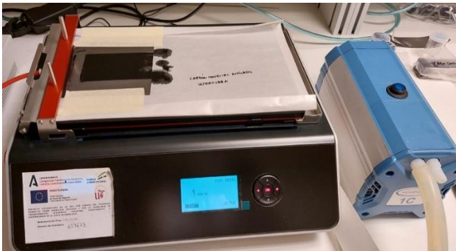
Imagen 4.6: Deposición de la pasta sobre el sustrato empleando TQC Sheen Automatic Film Applicator Compact
