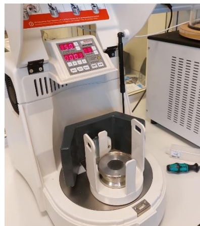
Imagen 4.3: Agitador del molino de bolas
