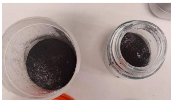
Imagen 4.5: mezcla de carbón fabricada antes de ser mezclada con el disolvente
