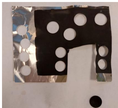
Imagen 4.9: electrodo circular de 14 mm de diámetro
