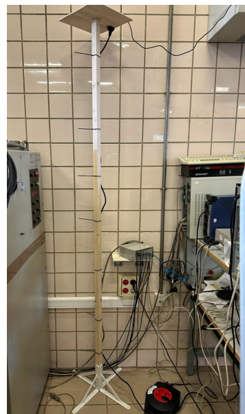
Figura 3.1 Soporte de madera elevado para colocación de la Raspberry Pi.
