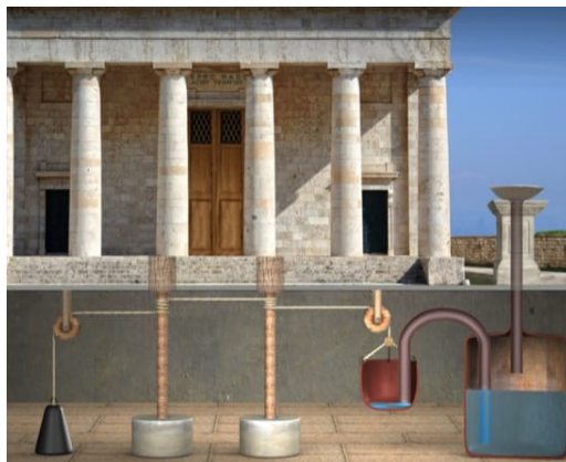
Figura 1.1 Puerta automática de Nerón.
