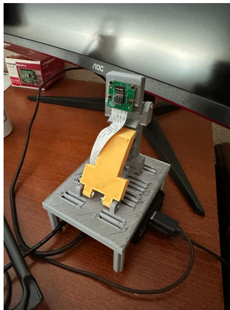
Figura 2.3 Imagen del ensamblaje de la Raspberry Pi con su soporte..
