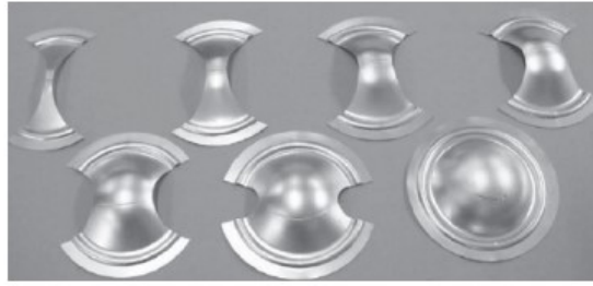
Figura 2.13 Geometrías de probetas en ensayos Nakazima [3].
