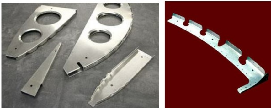
Figura 2.8 Piezas aeronáuticas típicas fabricadas por rebordeado [2].
