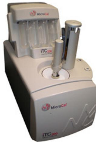
**Figura M.2. Calorímetro isotérmico ITC200 (Microcal)**
