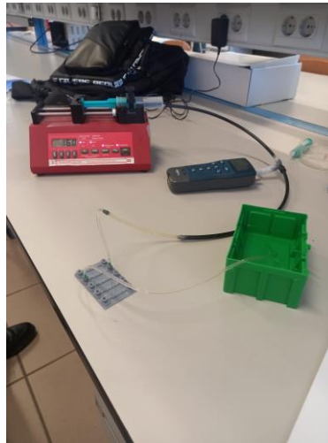
Figura 48 Sistema fluido total para el análisis de la microválvula de tesla
