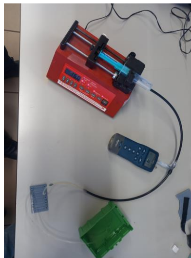
Figura 2 Sistema fluidoico vista superior con manómetro y bomba de jeringa automática
