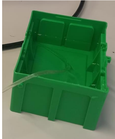
Figura 12 Contenedor plástico para el vaciado del líquido del sistema de la microválvula de tesla
