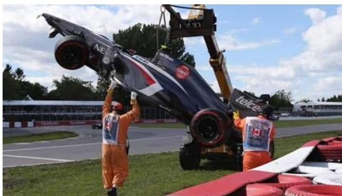
Figura 4-3. Operarios retirando un monoplaza averiado con ayuda de una grúa. Se puede observar cómo se pasa una cinta por la zona del arco antivuelco para poder retirarlo
