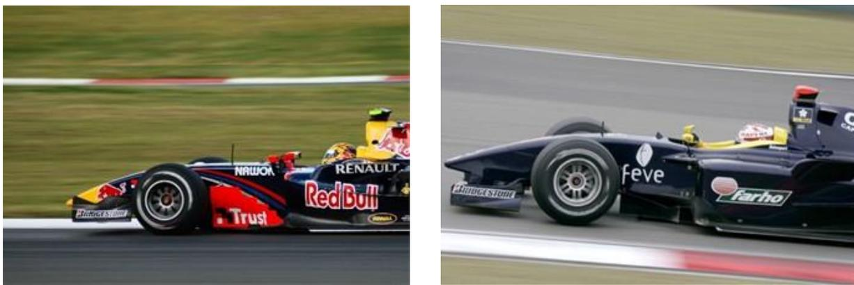
Figura 2-46. Monoplaza de GP2 (izquierda) y de GP2 Asia Series (derecha) en 2008. Nótese cómo ambos monoplazas presentan diferencias en la zona del habitáculo o en la sección lateral entre el neumático delantero y los pontones (los *bargeboards*, como se nombran en inglés)
