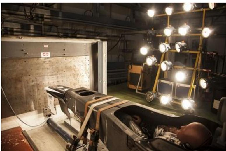
Figura 2-18. Imagen de una prueba de impacto (*crash test* en inglés) llevado a cabo por la FIA
