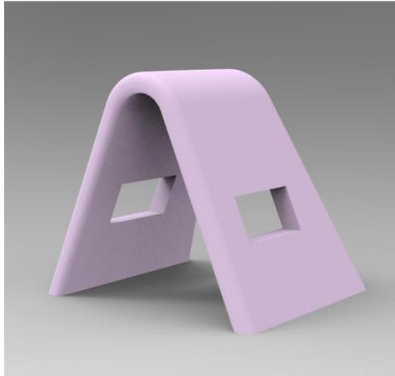
Figura 4-4. Modelo 3D del arco antivuelco
