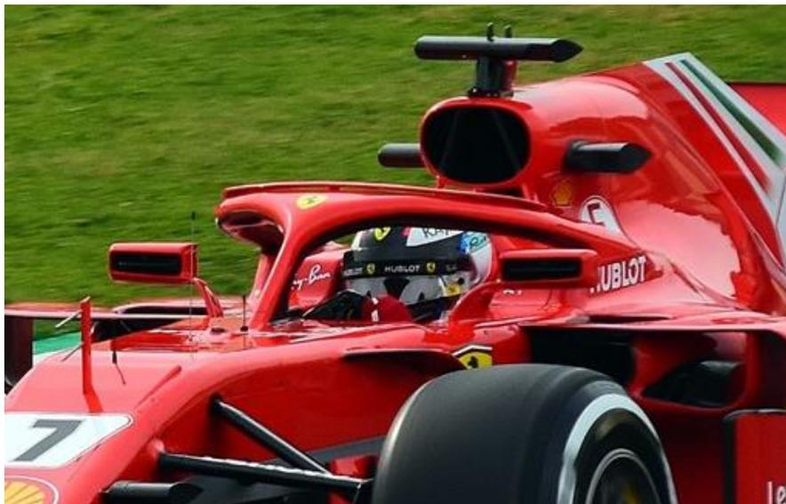
Figura 2-35. Ferrari SF71H de 2018, pilotado por Kimi Räikkönen. Se puede observar el Halo protegiendo la cabeza del piloto
