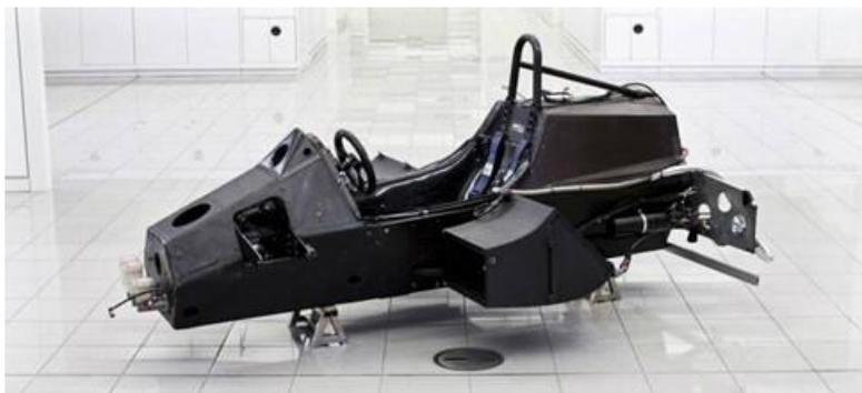
Figura 2-17. Monocasco del McLaren MP4/1
