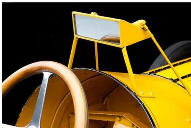
Figura 2-7. Espejo retrovisor montado en el *Marmon Wasp*
