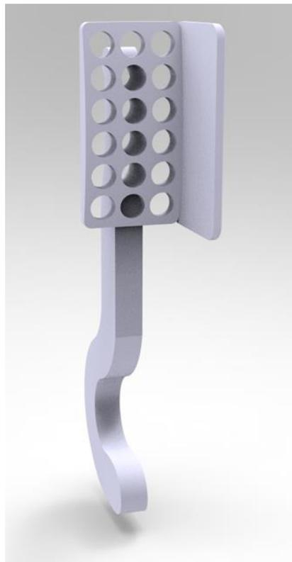
Figura 4-74. Modelo 3D del pedal de acelerador
