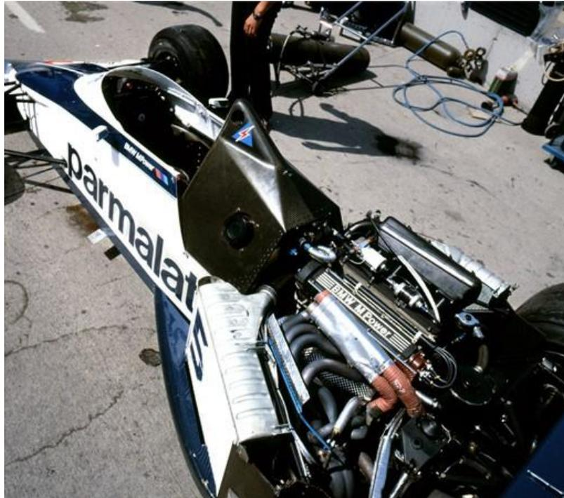
Figura 2-26. Motor BMW M12 montado en un Brabham BT52 en el GP de EE. UU. de 1983
