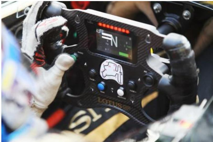
Figura 4-54. Volante XAP *Single Seater Series STW* utilizado en un monoplaza de GP2
