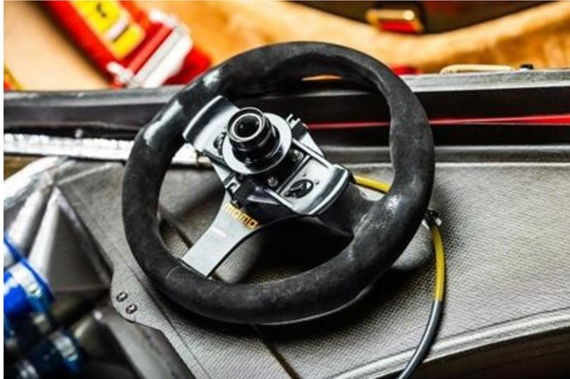
Figura 2-28. Volante del Ferrari 640 que participó en la temporada 1989 de F1. Nótese las levas para aumentar y reducir la marcha
