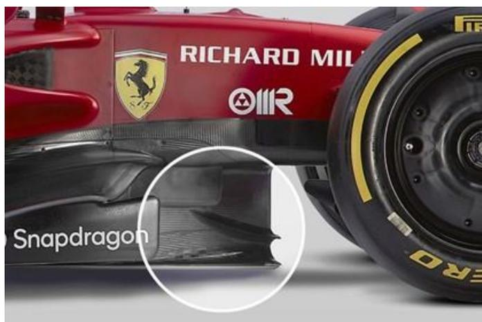
Figura 4-44. Splitter en un monoplaza
