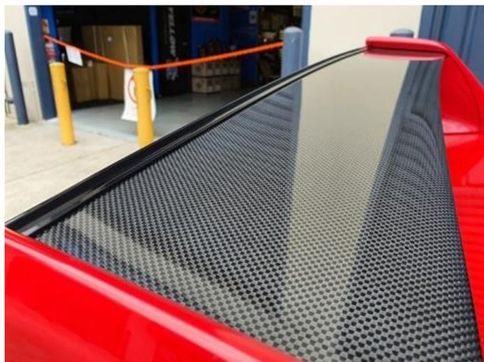
Figura 4-34. Detalle de un alerón con un Gurney Flap equipado. Este elemento, cuya sección transversal típica tiene forma de L, se coloca en el borde de salida del ala
