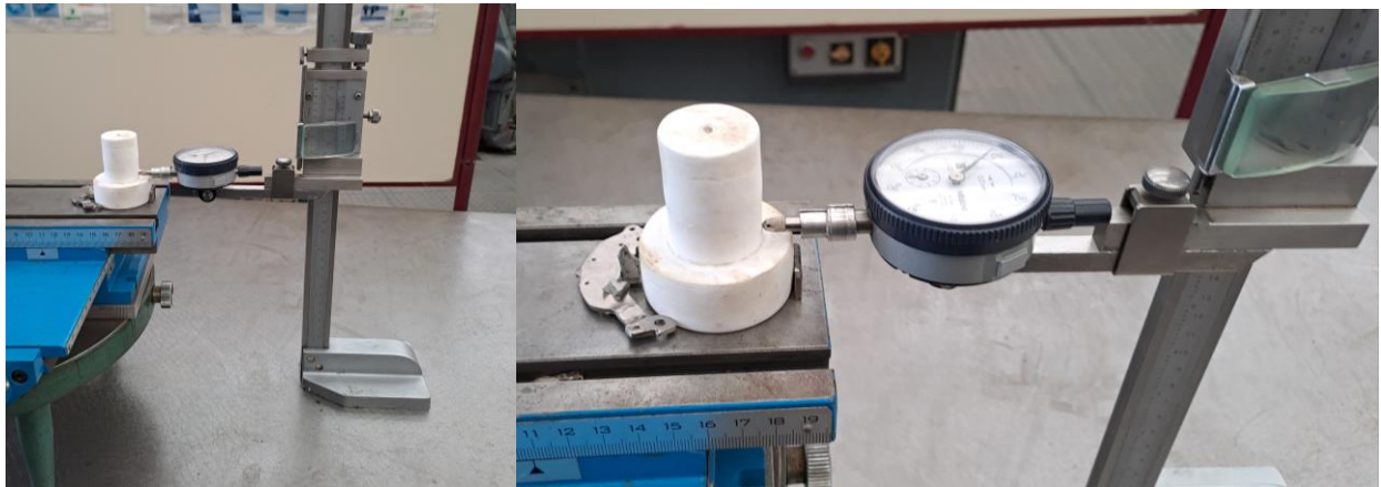
Figura 5.18: Montaje 2 para verificar la cilindridad.
