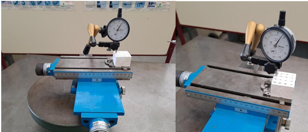
Figura 5.12: Montaje para verificar el paralelismo.
