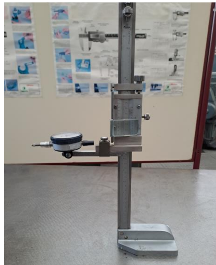
Figura 5.5: Soporte vertical para reloj comparador.
