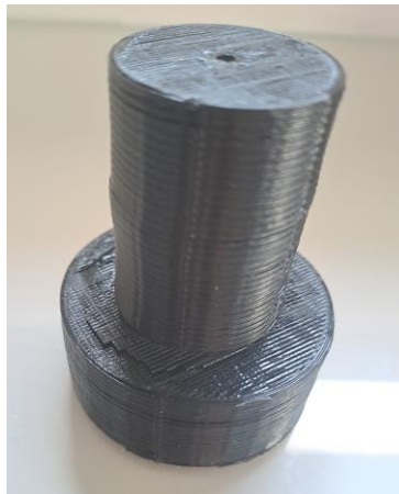
Figura 4.15: Pieza que ha sufrido delaminación.
