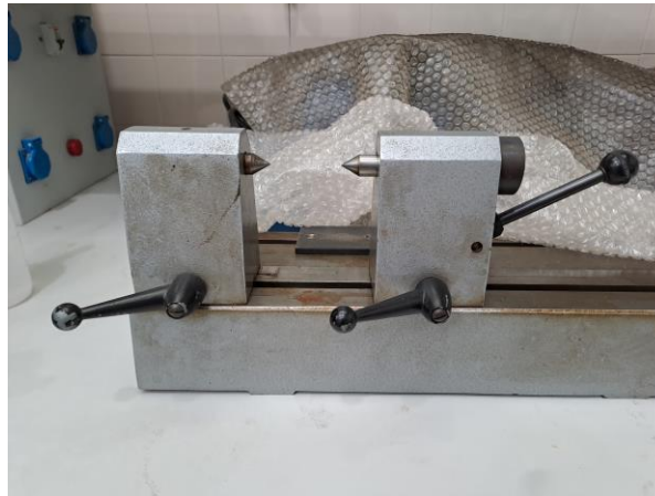
Figura 5.10: Bancada de dos puntos.
