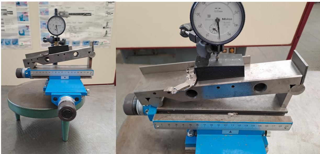
Figura 5.16: Montaje para verificar la tolerancia de inclinación.
