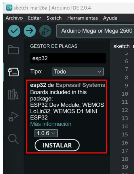
Figura C-6: Instalación de la placa ESP32 en el IDE de Arduino
