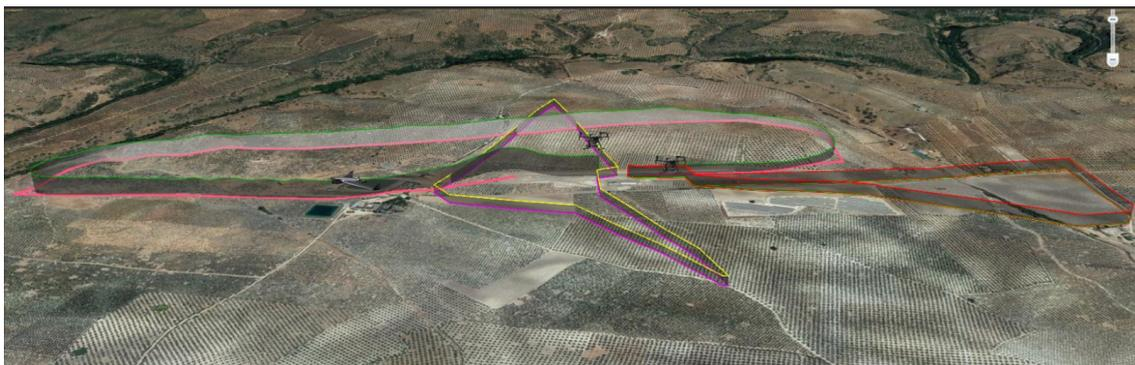
**Figura 5.6** Rutas ejecutadas por los UAVs en la misión conjunta de inspección de líneas eléctricas. .
