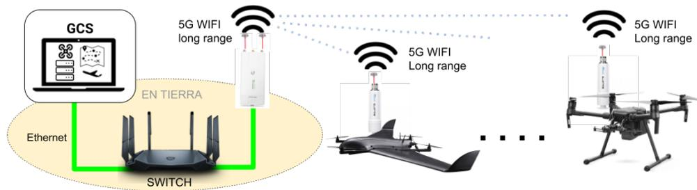
**Figura 2.2** Esquema del sistema de comunicación de enlace C2.
