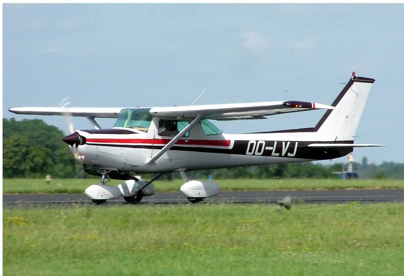
Figura 1.4 Cessna 152, avión que tiene como perfil alar el NACA 2412 [3].
