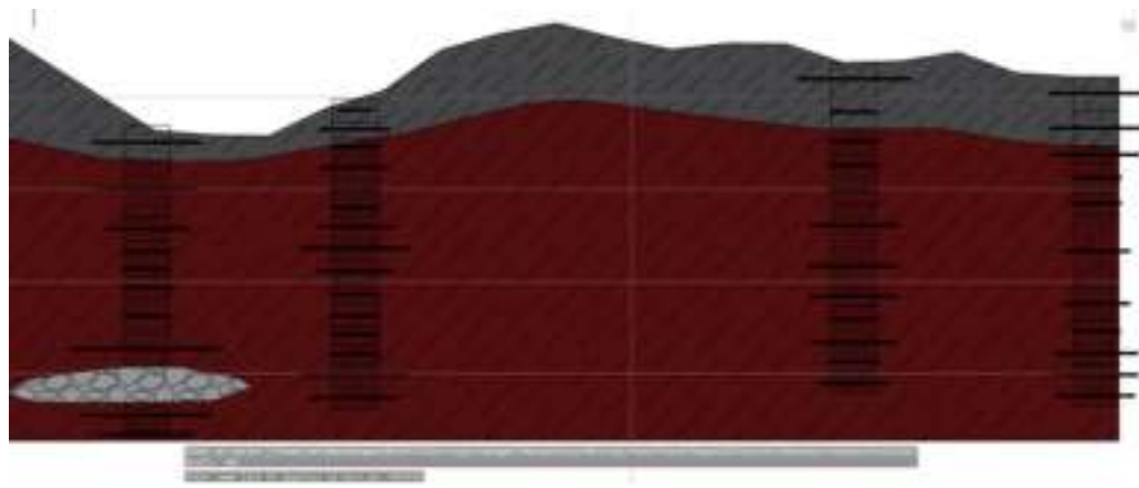
Figura 5.16 Esquema de localización de perfiles estratigráficos, información geotécnica e interpretación estratigráfica del perfil (fuente propia)
