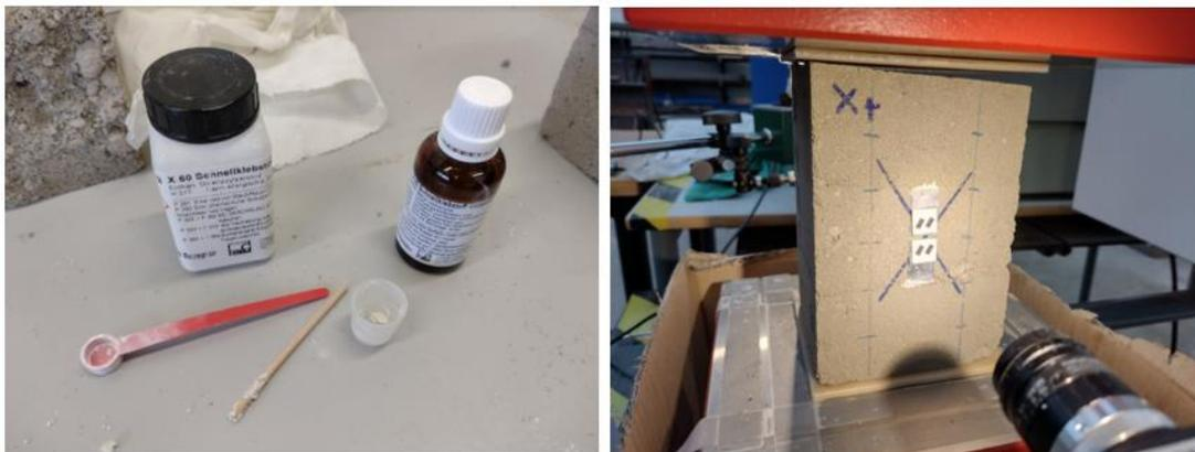
Figura 26. Patrones de medida junto con el adhesivo utilizado.
