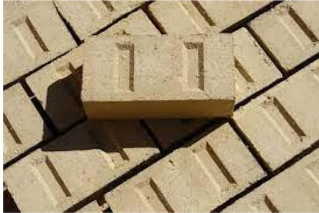
Figura 4. Bloque de Tierra Comprimida.
