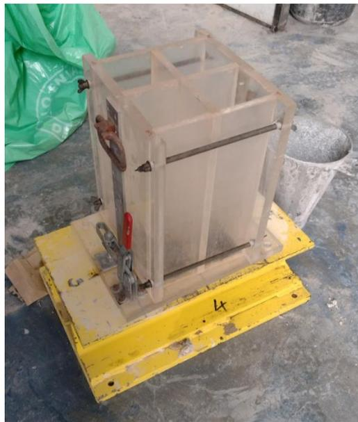
Figura 10. Molde utilizado en el proceso de fabricación
