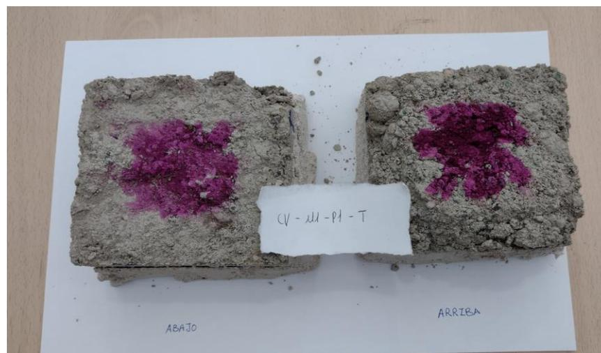
Figura 45. Ensayo carbonatación para la probeta CV-M1-P1-T
