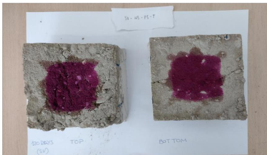
Figura 44. Ensayo carbonatación para la probeta SV-M3-P3-T
