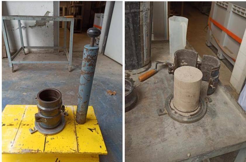
Figura 14. Ensayo Proctor normal
