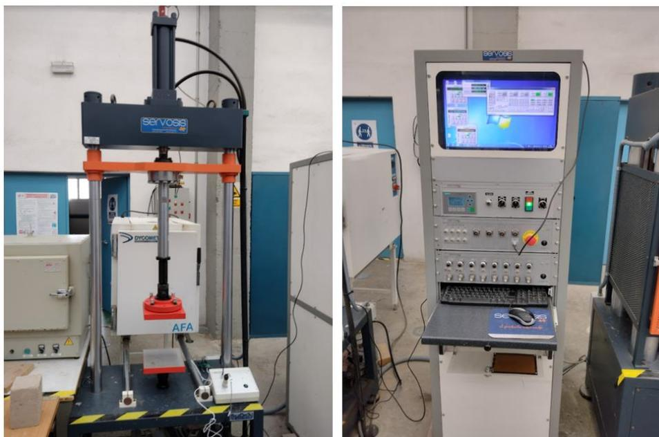
Figura 25. Máquina utilizada para los ensayos de compresión.
