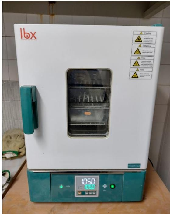
Figura 15. Estufa para el secado de probetas.
