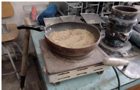
Figura 16. Proceso de secado mediante sartén.
