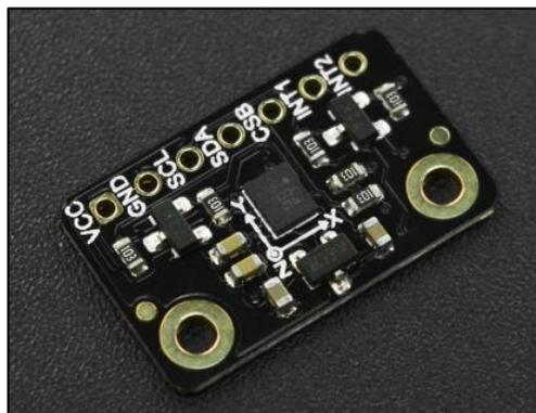
Figura 14. Fermion: BMX160 sensor de 9 ejes [22]
