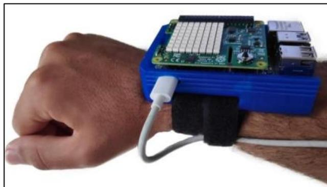
*Figura 3. Raspberry Pi + Sense Hat + Plataforma*
