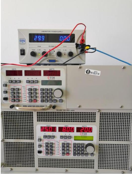
Figura 10 – Detalle de carga electrónica y fuente de alimentación
