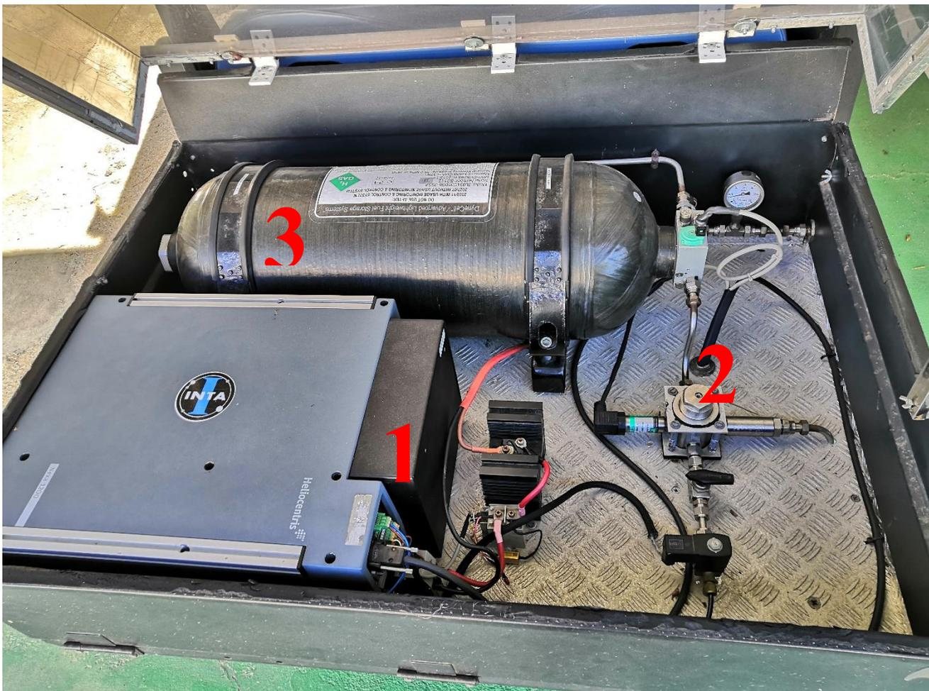
En la imagen se muestra la PEMFC junto con la electrónica de potencia (relé de carga y diodo de potencia montado en disipador de calor) [1], el sistema de reducción de presión junto con el sensor de baja presión [2] y el tanque de almacenamiento de hidrógeno [3], donde se encuentra el sensor de temperatura y de alta presión
