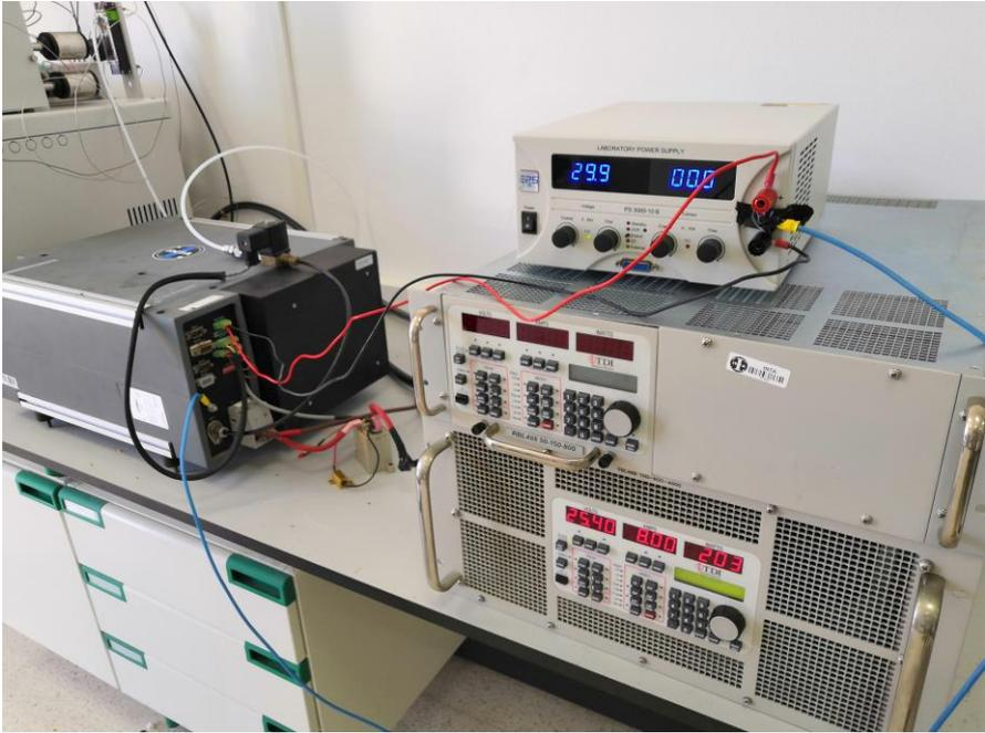
Figura 9 – Componentes para caracterización de la pila de combustible
