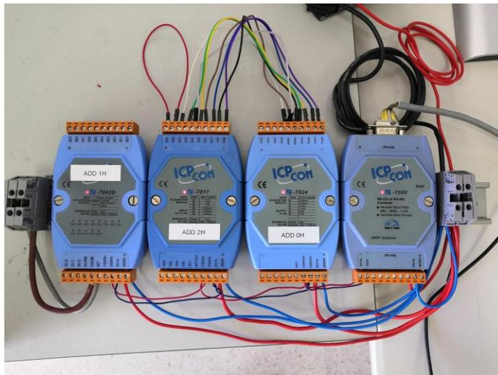
Figura 26 – Detalle cableado TADs durante su configuración
