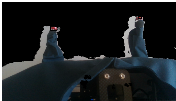
Figura 4.8 Detección del marker rojo con filtro de profundidad.
