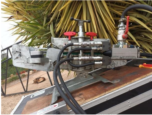
Fotografía 28, 29 y 30: sistema de conductos por donde llega el aire a presión desde el compresor y acaba en el conducto de la arqueta pasando antes por una maquinaria que fija debidamente el cable para que no sufra torsiones.
