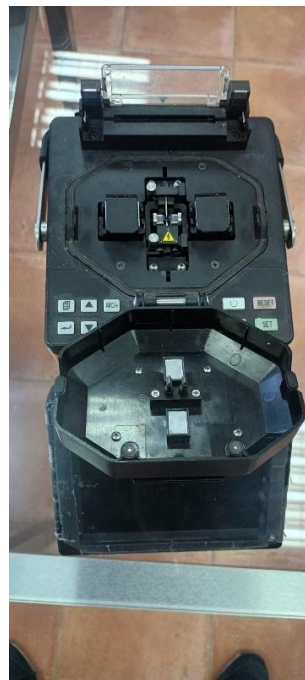
Fotografía 35: fusionadora con la que se hacen los empalmes. Se aprecia en la parte central de la máquina los dos electrodos donde saltará el arco eléctrico teniendo los dos extremos de fibra óptica enfrentados. Fuente: foto del autor.
