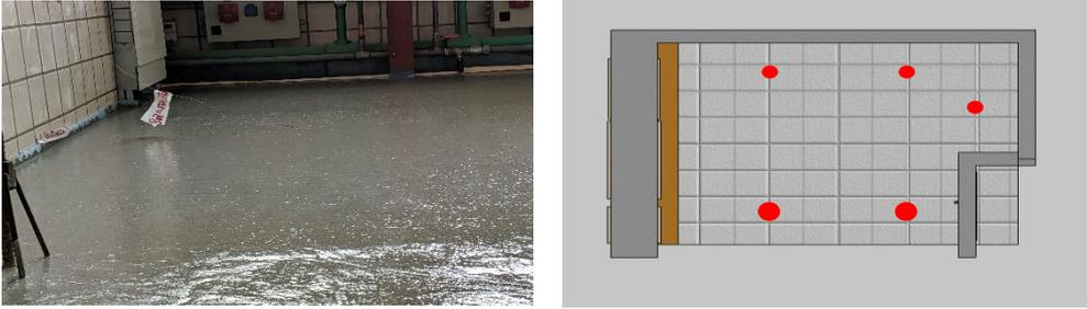
Figura 18. Monitorización en panel radiante.
