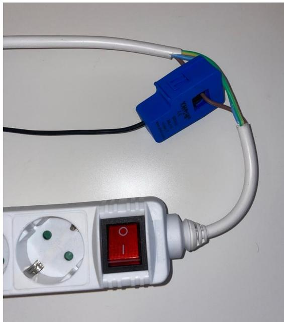
**Figura 5.18** Instalación del SCT para la realización de pruebas.
