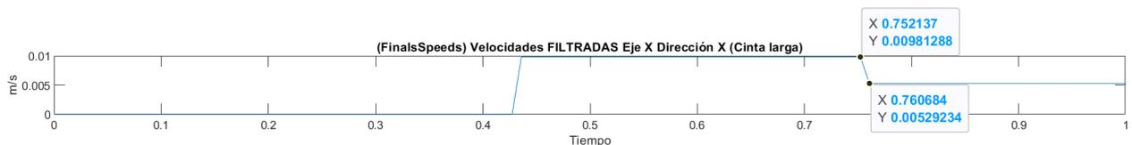
Figura 5.13 Gráfica de FinalsSpeeds para obtener el valor de DeltaCintaX.
