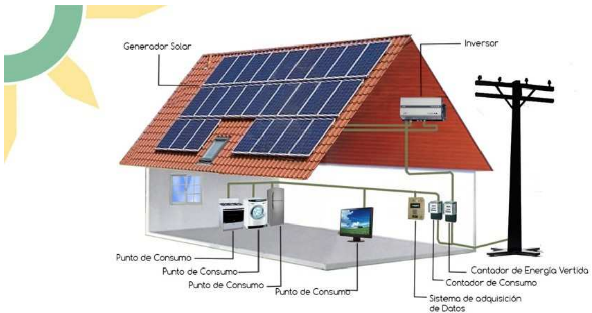
Imagen 75: Funcionamiento placas fotovoltaicas. 115
