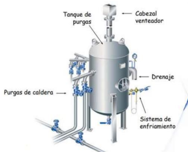
Figura 47. Tanque de purgas de caldera [34]
