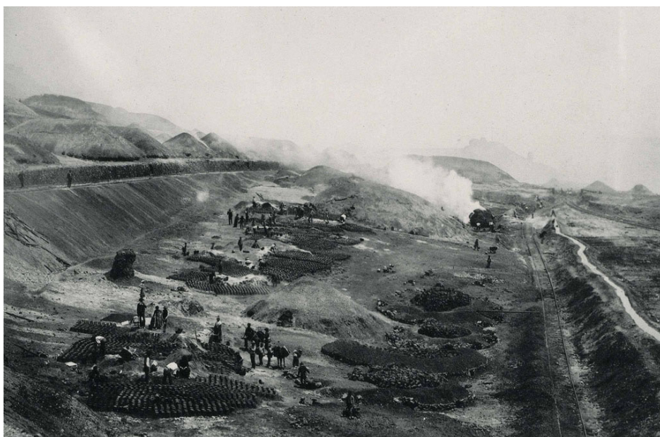
TELARES DE CALCINACIÓN de mineral en Riofinto, Huelva, en una fotografía de 1892. Fuente: Junta de Andalucía.
