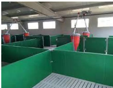
*Figura 11: Separadores Laterales de Material Polimérico.*
