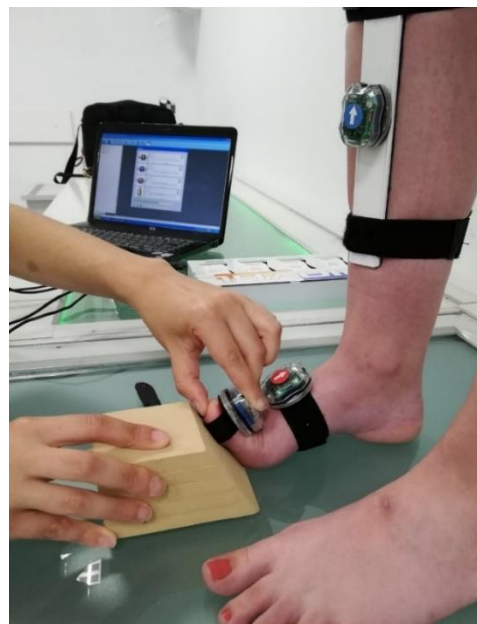
Figura 34. Colocación cuña con una inclinación de 60º
