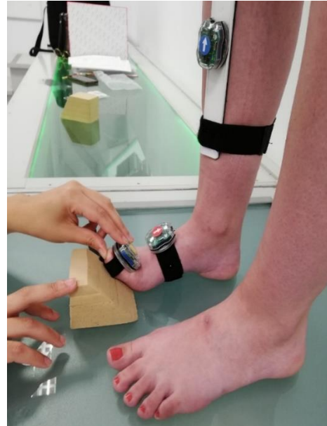
Figura 32. Colocación cuña con inclinación de 45º
