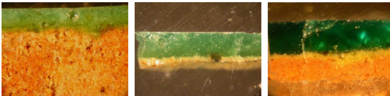
Figura 2 – Microfotografías de estratigrafías de cerámicas de color verde con distintos porcentajes de SnO 2 (8,76%, 3,44% y ≈ 1%).
