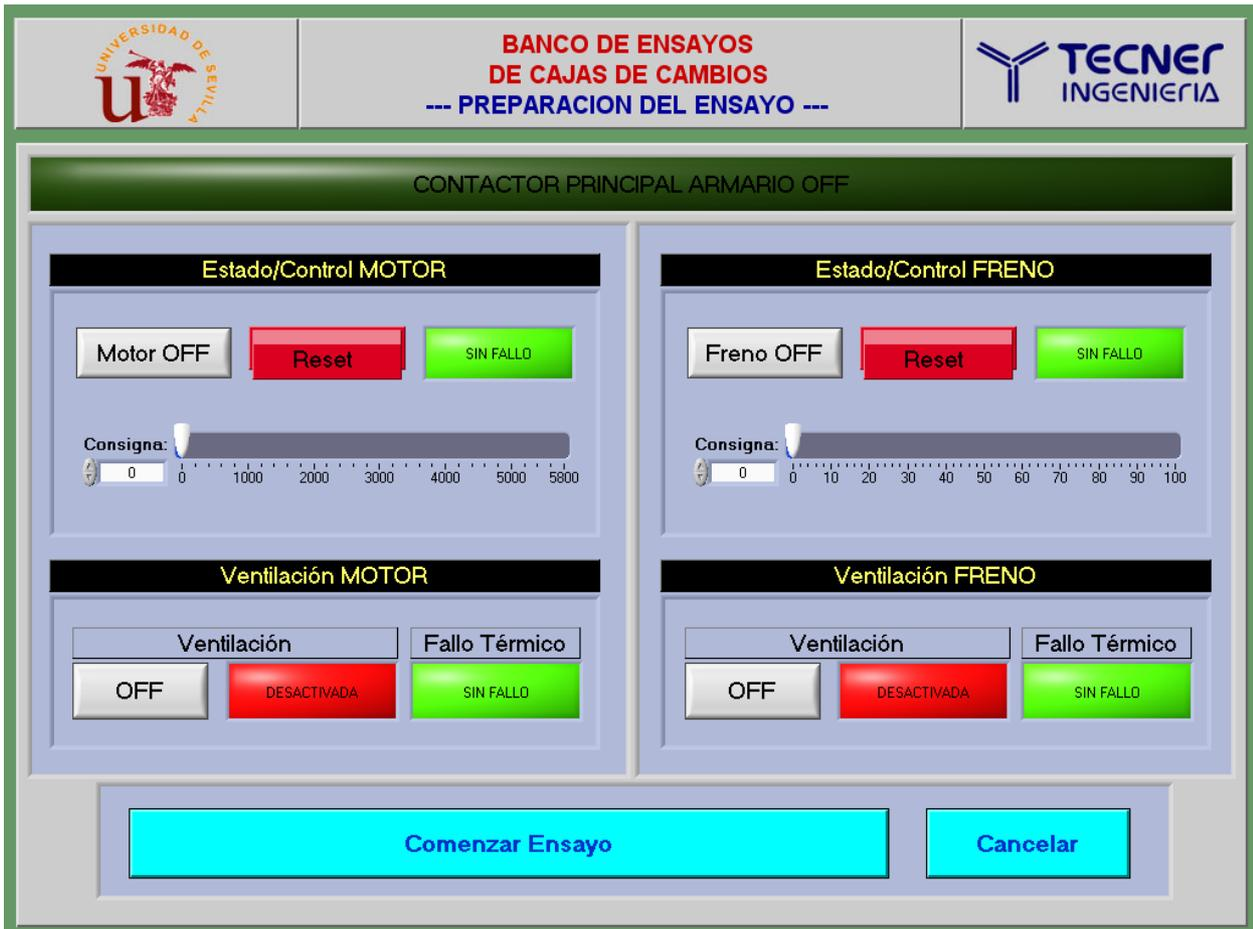
Figura 40. Control manual del banco de ensayos
