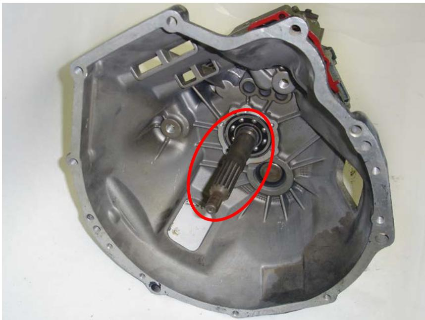
Figura 55. Eje primario de la caja de cambios
