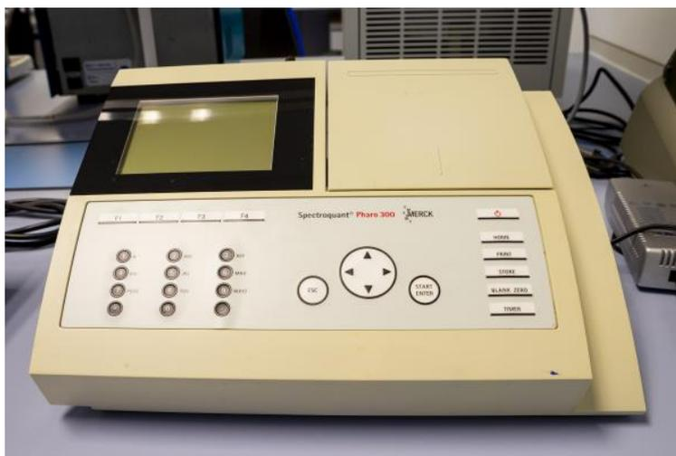
**Figura 1-9:** Espectrómetro UV/VIS Merck Spectroquant© Pharo 300.
