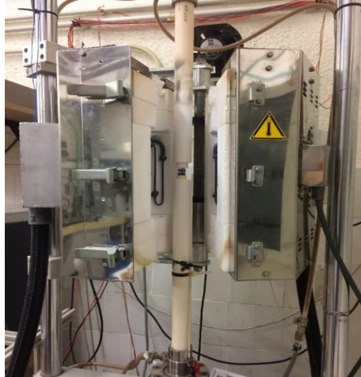
Figura 46. Máquina de ensayo de compresión con horno de resistencia acoplado (Laboratorio de Física de la Materia Condensada, Universidad de Sevilla).
