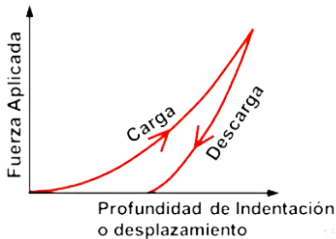
Figura 31. Curva de carga y descarga durante un ensayo de indentación.
