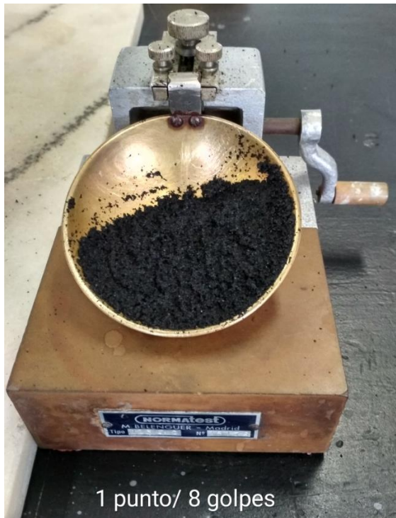
Ilustración 15. Ensayo de límites de Atterberg del granulado de NFU's (polvo D < 0,8 mm).
