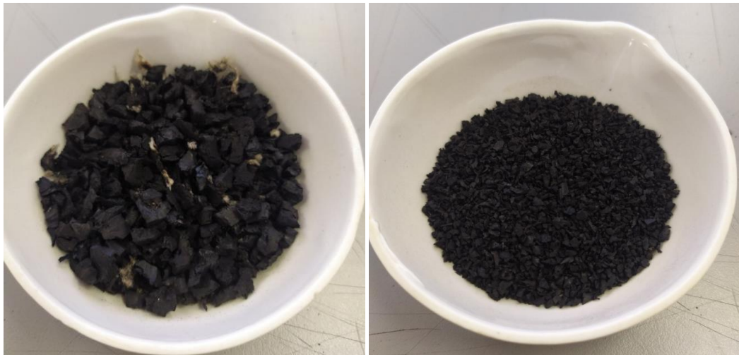
Ilustración 38. Granulometría S 5 (90% S 4 2,0 – 7,0 + 10% S 2 0,6 – 2,0 mm), material propuesto para la reparación del vial de acceso de la Urbanización Cármenes del Mar, Almuñécar.
