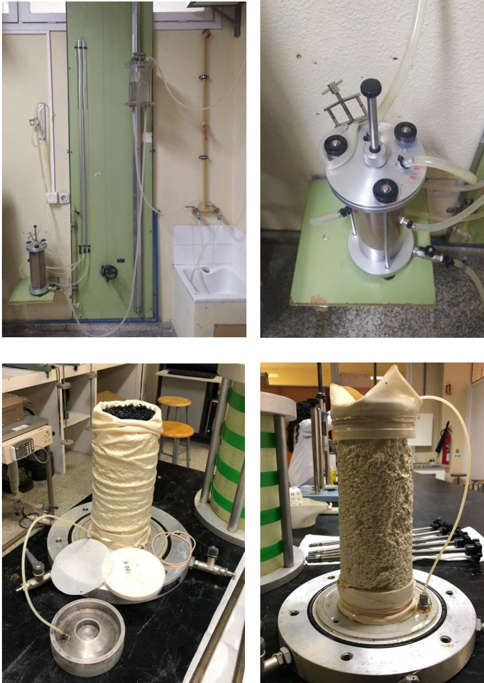
Ilustración 32. Ensayo de Permeabilidad y montaje de los granulados NFU's.
