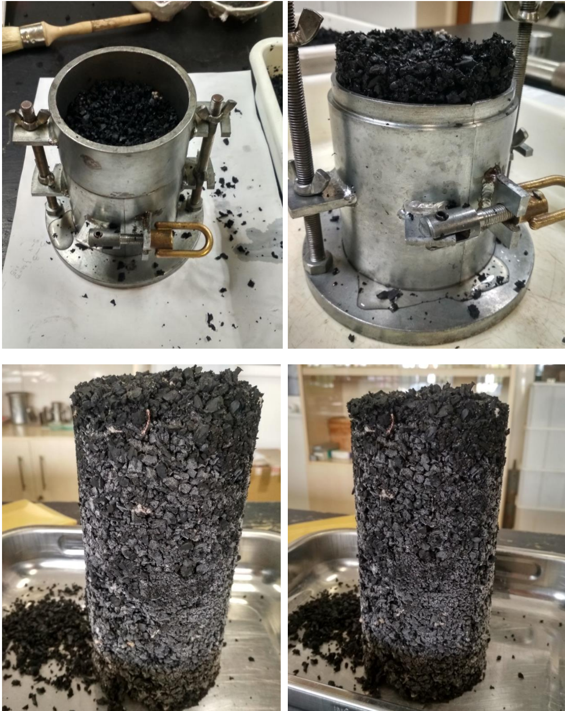
Ilustración 20. Montaje y desmontaje del ensayo de Próctor de los granulados NFU's (Muestra S7).
