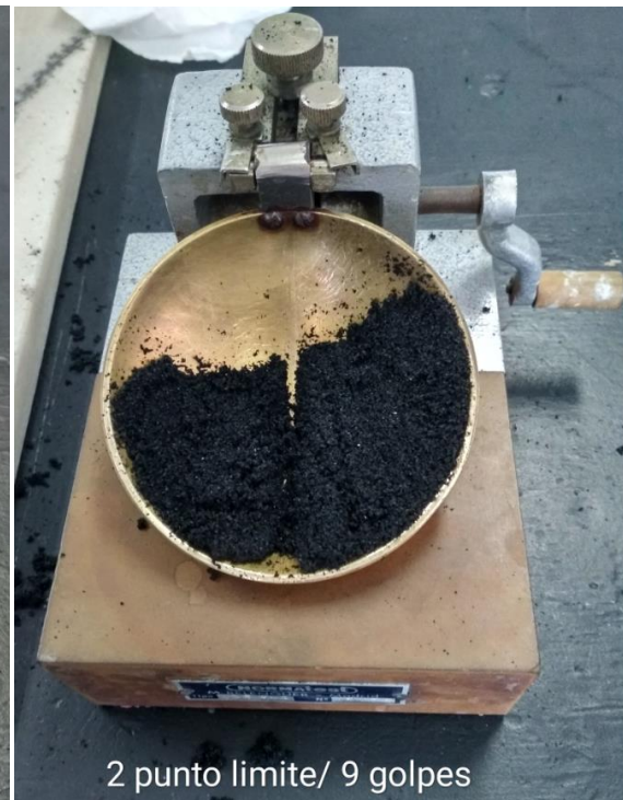
Ilustración 15. Ensayo de límites de Atterberg del granulado de NFU's (polvo D < 0,8 mm).
