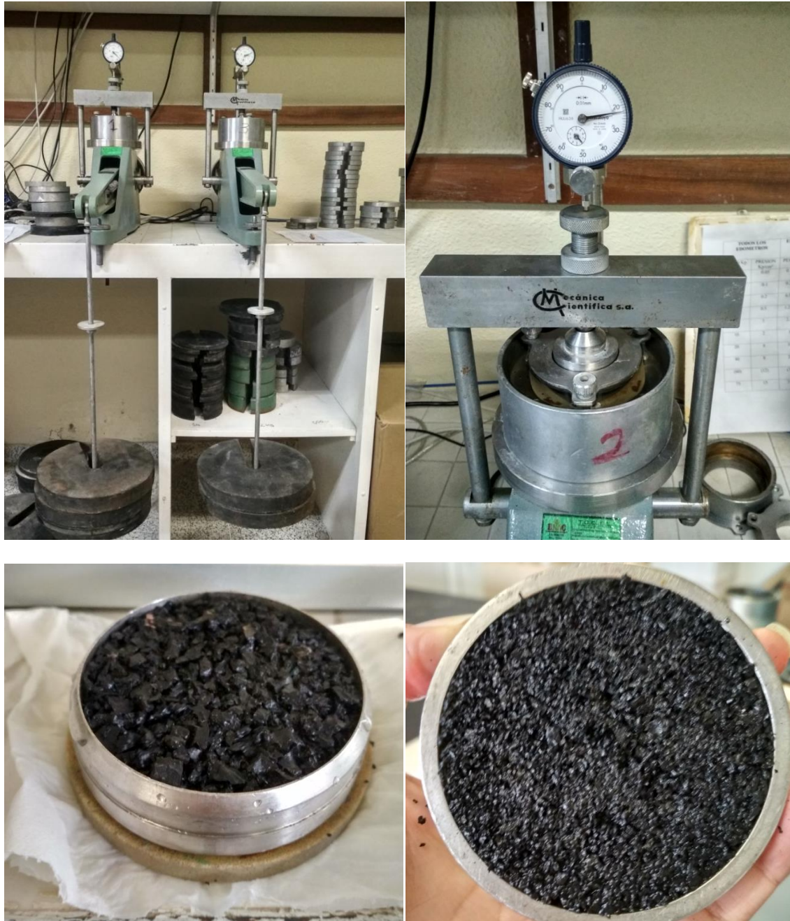
Ilustración 28. Preparación y montaje de ensayos edométricos del granulado de NFU's.
