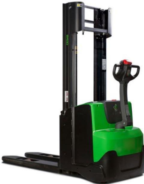
Las cajas del producto terminado llegan al almacén refrigerado transportadas con un apilador del fabricante Carretillas2000, concretamente el modelo CESAB S 212 [22] mostrado en la Figura 18.
