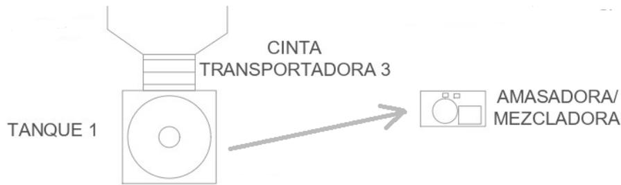
**Figura 9.** Cinta transportadora 3, tanque de recepción 1 y amasadora/mezcladora.
